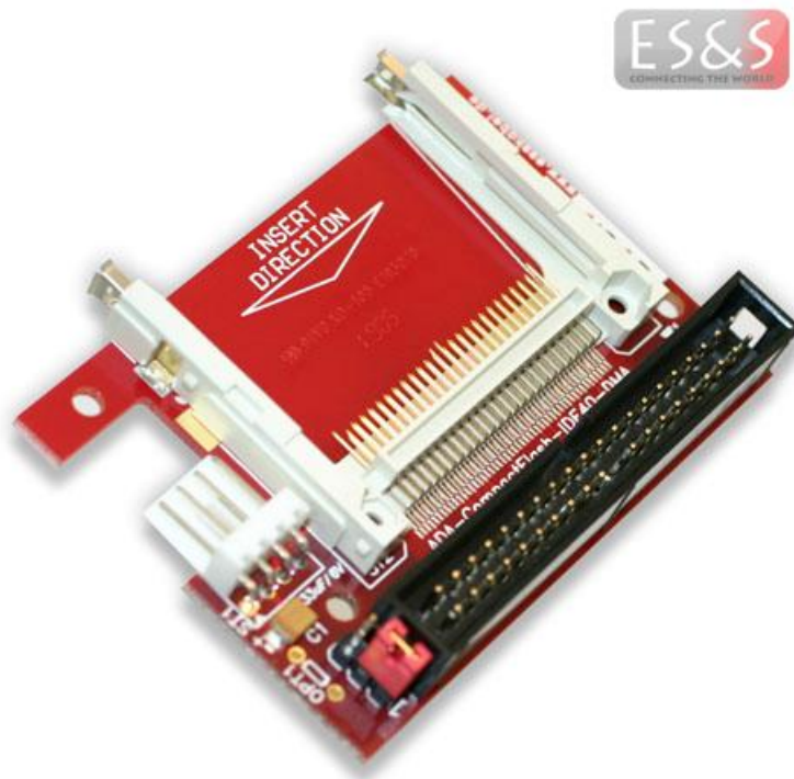
Compactflash zu IDE40 Adapter - lange CF Sockelausführung
